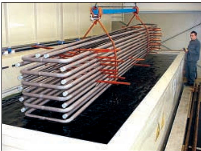
In dieses Becken mit 24 Kubikmetern salpetersäurefreiem Beizbad PREMIUM taucht ein Mitarbeiter das 6 m lange Rohrbündel aus Edelstahl. Foto: Schaareschuh
