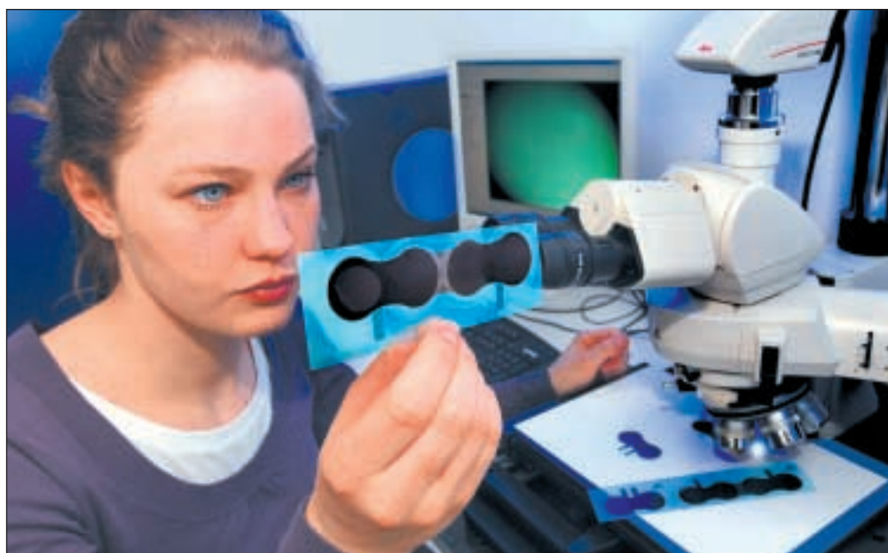
Am Institut für Print- und Medientechnik prüft Mitarbeiterin Ulrike Geyer ein gedrucktes Batteriemodul. Die dünnen und flexiblen Produkte versorgen elektronische Bauelemente wie Chips und Karten. Auch der Einsatz in der Medizintechnik, z.B. zur Überwachung von Körperfunktionen ist möglich. Foto: TU Chemnitz/Thieme
