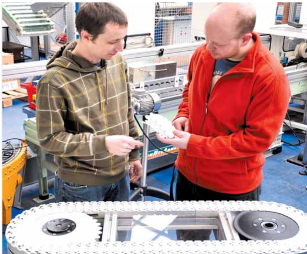
Wissenschaftler der TU testen eine neuartige Gleitförderkette aus Kunststoff, deren langlebige Kettenglieder helfen, im Vergleich zu herkömmlichen Lösungen Antriebsenergie zu sparen. Foto: TU Chemnitz
