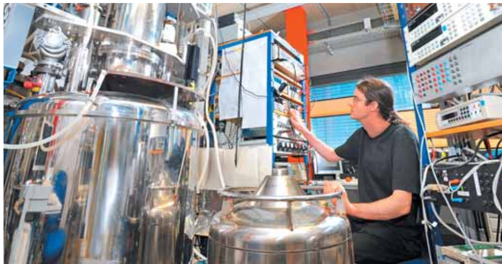
Martin Stiehler von der Professur Physik arbeitet im Rahmen seiner Doktorarbeit an einer Anlage, die bei tiefen Temperaturen den elektrischen Widerstand metallischer Legierungen misst. Foto: Wolfgang Thieme
