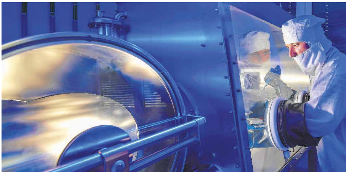
Eric Pankenin, Wissenschaftlicher Mitarbeiter an der Professur für Materialsysteme der Nanoelektronik, überprüft in einem Reinraum die Funktion einer hermetisch und gasdicht abgeschlossenen Glovebox. In dieser Box kann mit empfindlichen oder gefährlichen Materialien in einer abgeschotteten Schutzgasatmosphäre gearbeitet werden.
