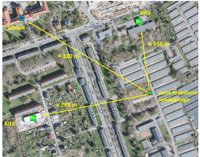
Das Luftbild zeigt die Abstände des Mastes zu sensiblen Einrichtungen. Foto: Stadt Chemnitz.
