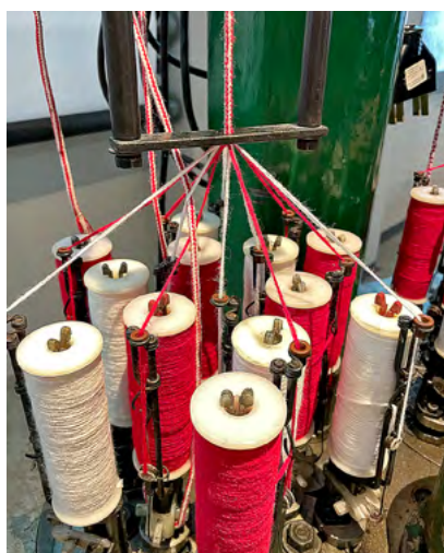
Im Interaktiven Museum für Industrie in der bulgarischen Stadt Gabrovo ist unter anderem diese Maschine zum Flechten von Seilen ausgestellt. Foto: Industriemuseum Chemnitz
