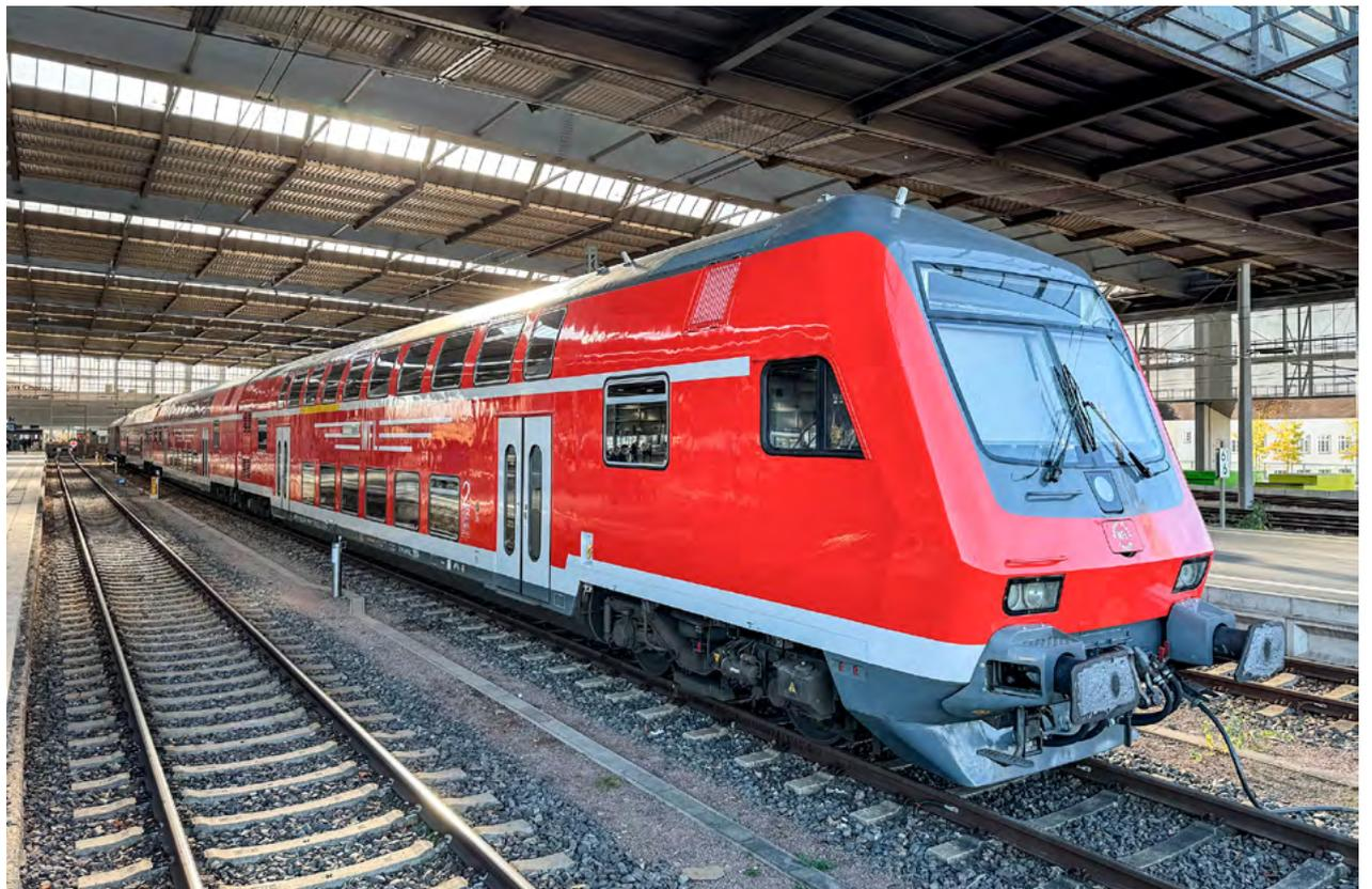
Die Doppelstockwagen verfügen über Klimaanlage, barrierefreie Toiletten, Mehrzweckabteile und niveaugleiche Eingänge mit den Bahnsteigen sowie moderne, leise Scheibenbremsen. Die Türen lassen sich bequem per Knopfdruck öffnen. Fotos: Ingolf Wappler
