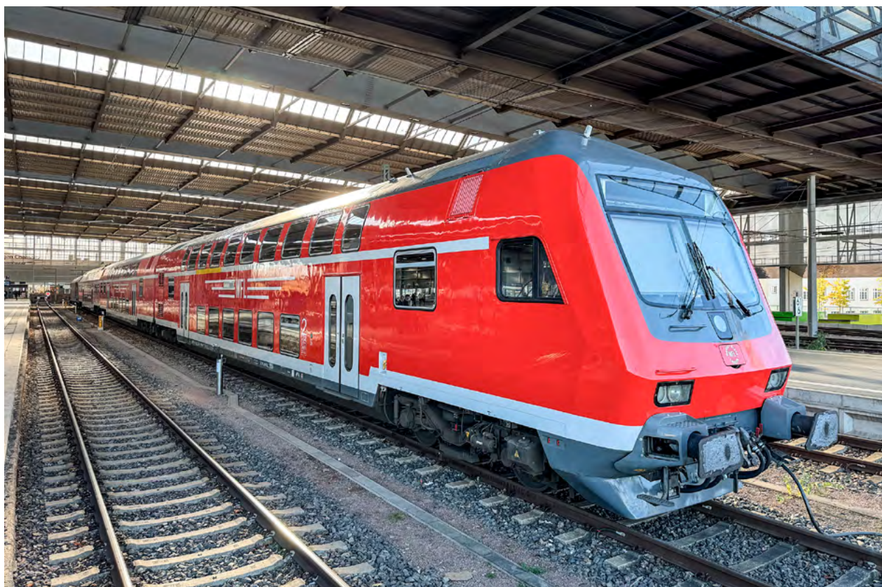
Die Doppelstockwagen verfügen über Klimaanlage, barrierefreie Toiletten, Mehrzweckabteile und niveaugleiche Eingänge mit den Bahnsteigen sowie moderne, leise Scheibenbremsen. Die Türen lassen sich bequem per Knopfdruck öffnen. Fotos: Ingolf Wappler
