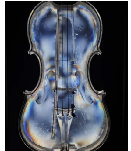
Spannungsoptische Untersuchung bei einer Violine, 2014. Foto: Ganbat Ganbold
