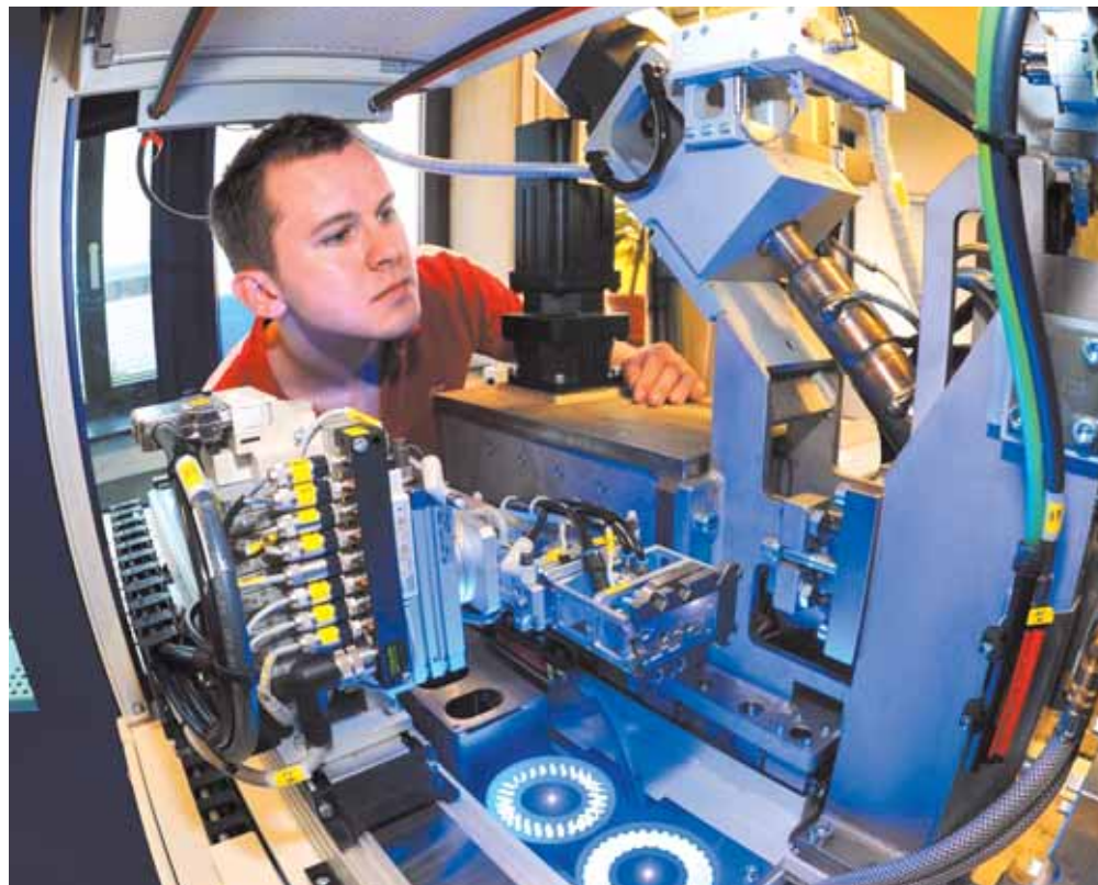
Marcel Köber, Technischer Angestellter der TU arbeitet an einer neuen Mikrospritzgießanlage, die es deutschlandweit bisher nur in Chemnitz gibt. Foto: TU Chemnitz
